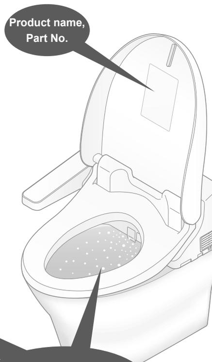
Une brume est automatiquement pulvérisée dans la cuvette, ce qui empêche les salissures d'adhérer à la surface.
